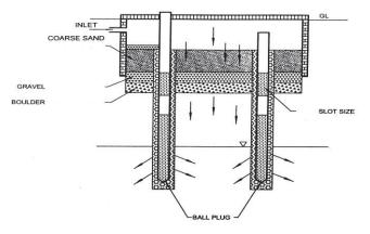
FIG. 18 ARTIFICIAL GROUND WATER RECHARGE STRUCTURE
